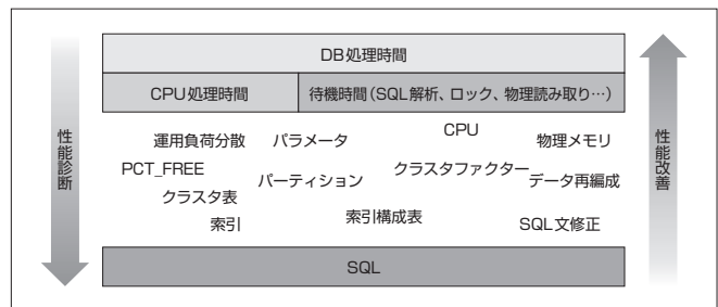
図10：性能診断と性能改善のアプローチ
